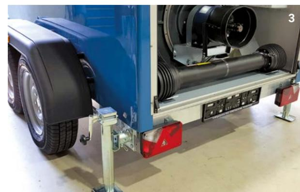
1. Grand refroidisseur à résistance de charge qui permet les tests en continu des engins à fortes puissances.
